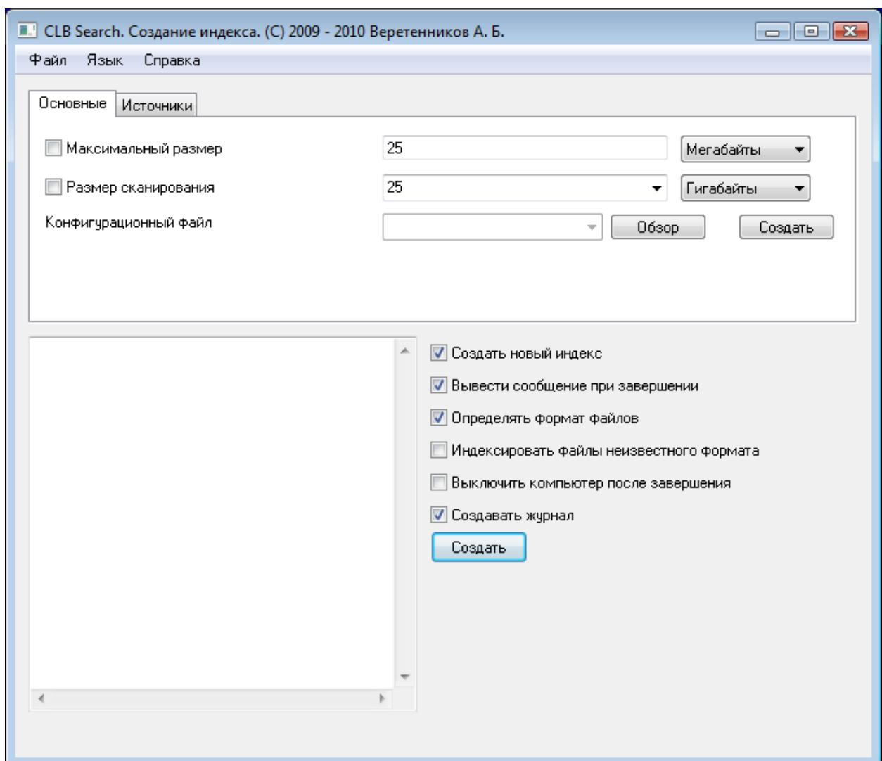
На первой закладке можно в поле «Максимальный размер» указать максимальный размер файлов, который следует проиндексировать, при достижении данного размера индексирование останавливается.
