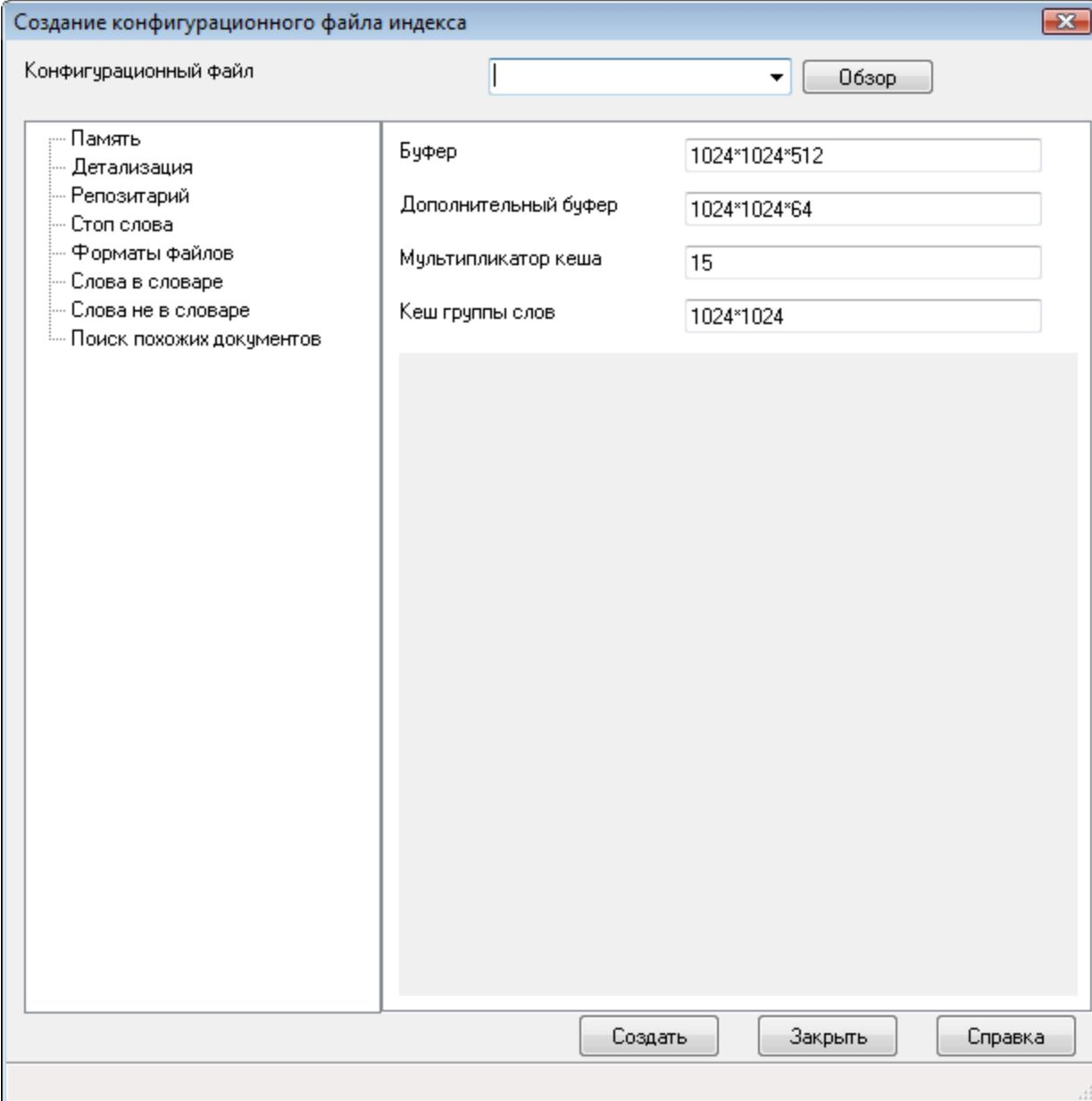
Поле «Конфигурационный файл» является выпадающим списком. В данном списке присутствует несколько вариантов шаблонов, предназначенных для компьютеров разной производительности.
