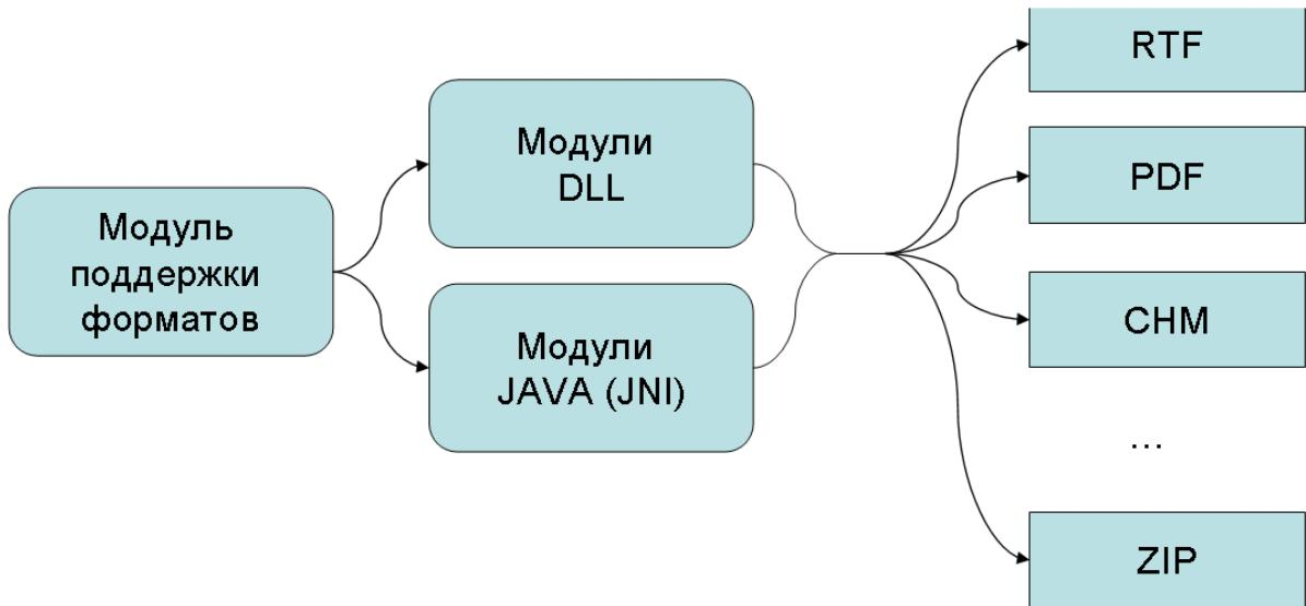
Модуль поддержки форматов реализует уровень изоляции дополнительных модулей от ядра программы.
